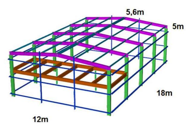
Largeur = 12m Longueur = 18m Hauteur au plus bas = 5m Hauteur au faîtage = 5.6m.
