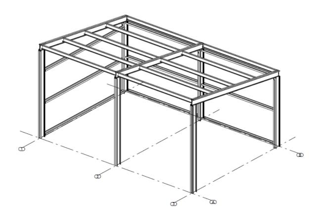
Largeur =7m Longueur = 10m Hauteur au plus bas = 4m Hauteur au plus haut = 5m.
