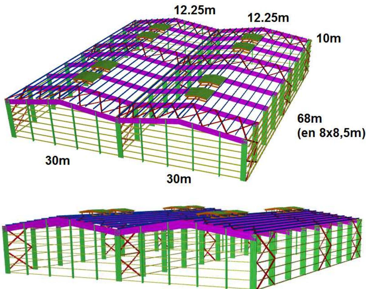
**Largeur = 30m + 30m    Longueur = 68m    avec H1= 10m et H2=12.25m**
